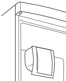
Устройство активируется самостоятельно по мере необходимости, например, с целью быстрого восстановления температуры после открытия двери или в условиях высокой окружающей температуры.
