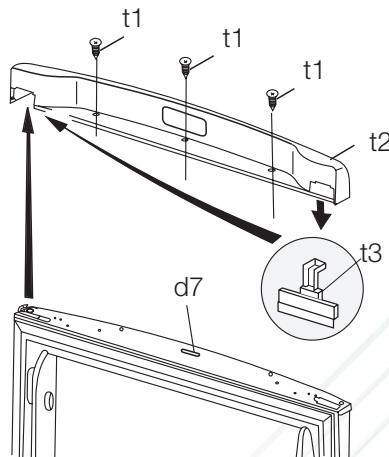
2. Снимите пластмассовую крышечку с пластмассовой декоративной полоски дверцы и установите ее на противоположной стороне (t3).
